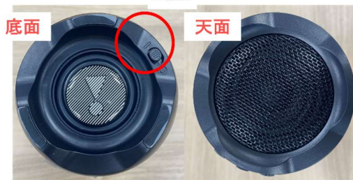
模倣品 底面に「！」マークのシール 天面に網 SDカードスロットあり ビニールの巻物付き 底面にOn/Offスイッチあり
